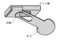
グロメット(ゴムパッキン)を取り外し穴を利用します。 インプルナット取り付け後にアングルを固定しボルトで締め付けます。
