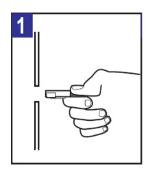
インプルナットのタブを図1 のように持ち穴に挿入します。
