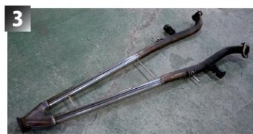
↑純正サブタイコがあった場所に、新たにパイプを溶接。2本のパイプ間に「プレ止め」用のステーも付けた。ちなみにセンスでは、溶接にステンレス製の「フラックス入りワイヤー」を使用。見た目はもちろん、サビを防ぐ効果もある
