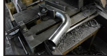
↑90度の曲げパイプを分度器で測りカットすることで、様々な角度のパイプが作れるのだ!
