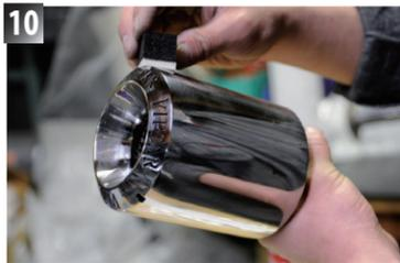
↑最後は、耐熱硬度ガラスコーティング剤で仕上げる。パフの磨きキズも消え、「超鏡面」に!
