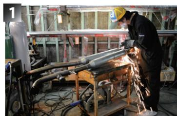
↑前後の純正パイプを残し、サブタイコをカット。「サブタイコ」を取ることで音量の変化はもちろん、最低地上高も確保できます。今回は溶接と同時にマフラーハンガーフックの位置を下げ、底上げも行いました
