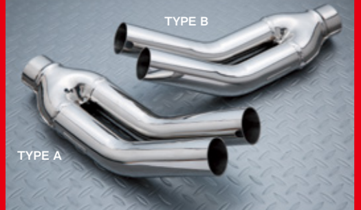
テールエンドの汎用品としても販売中。出口から向かって見て右側に振り角が付いた方がタイプA、左側に振っているのがタイプBとなる。基本サイズは高さ120ミリ×横幅115ミリ×長さ380ミリ×パイプ内径50.8ミリ。装着にあたっては要溶接
